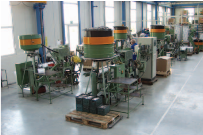
Automatische Test- und Montagemaschinen für Verankerungskeile
