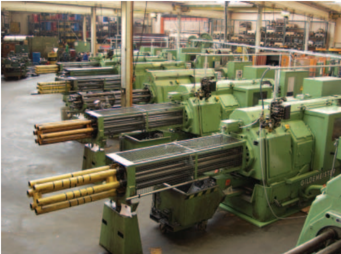
Drehautomaten für die Herstellung von Verankerungskeilen
